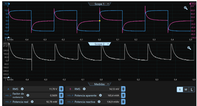
Figura 20: Aplicación sobre tejidos corporales con alterna rectangular 4 KHz 12 Vp. Electrodo metálico recubierto de gamuza humedecida.
