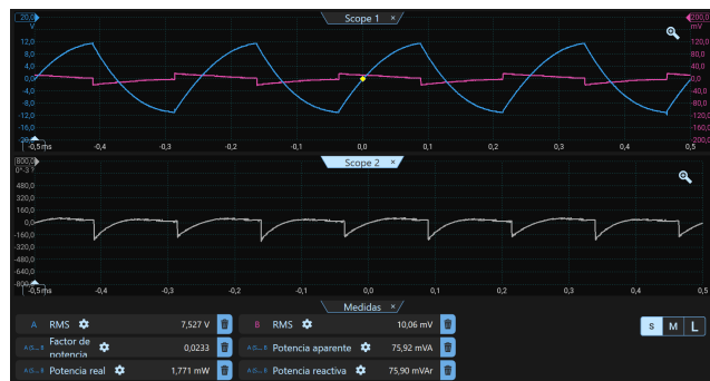
Figura 16: Aplicación de alternas rectangulares sobre carga artificial C o un condensador solamente.
