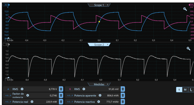
Figura 15: Aplicación de alternas rectangulares sobre carga artificial RC en paralelo.
