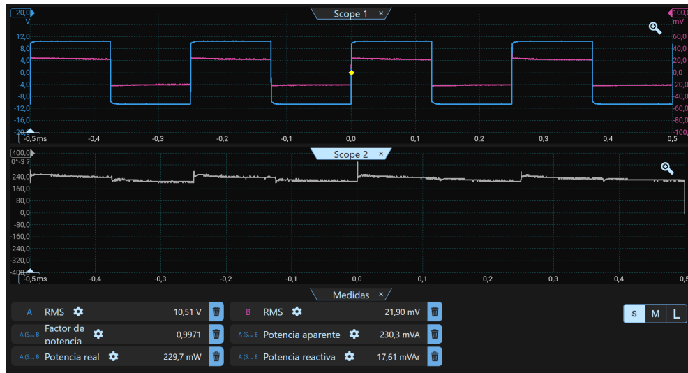
Figura 7: Ondas alternas cuadrangulares aplicadas sobre resistencia pura.
