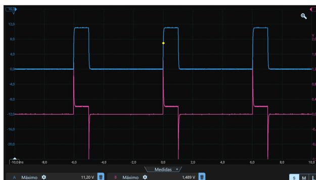
Figura 21: Monofásica cuadrangular de 1 ms de pulso y 5 ms de reposo sobre RC en modo VC.
