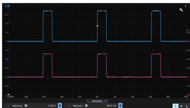
Figura 18: Monofásica cuadrangular de 1 ms de pulso y 5 ms de reposo sobre R pura en modo CC.
