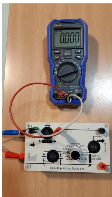
Figura 4: Medida de intensidad directamente con multímetro.
