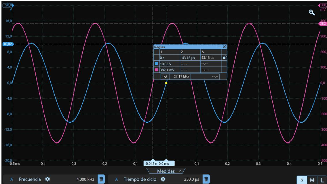
Figura 13: Corriente sinusoidal de 4.000 Hz, 250 μs de período y 43,16 μs de desfase. Las guías verticales miden el desfase y las horizontales los voltajes de pico.
