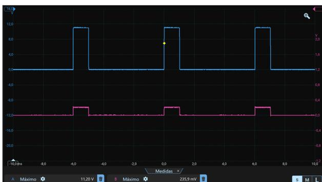
Figura 20: Monofásica cuadrangular de 1 ms de pulso y 5 ms de reposo sobre R pura en modo VC.
