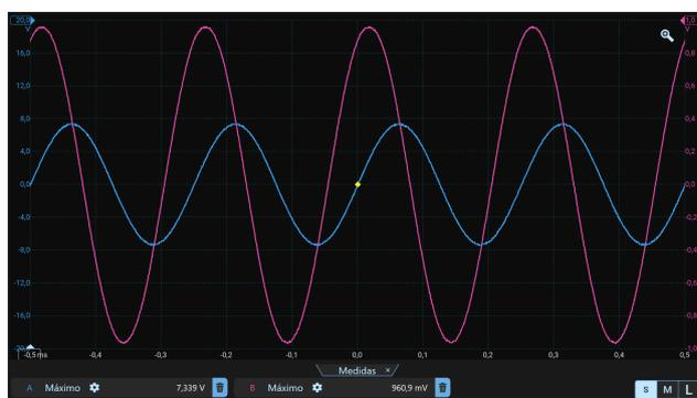
Figura 11: Alterna sinusoidales sobre R de 500  $\Omega$  y C de 470 nF.
