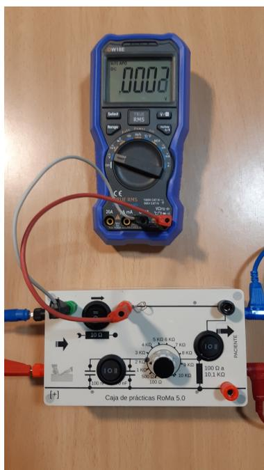
Figura 5: Medida de intensidad sobre R1 de 10  $\Omega$ .
